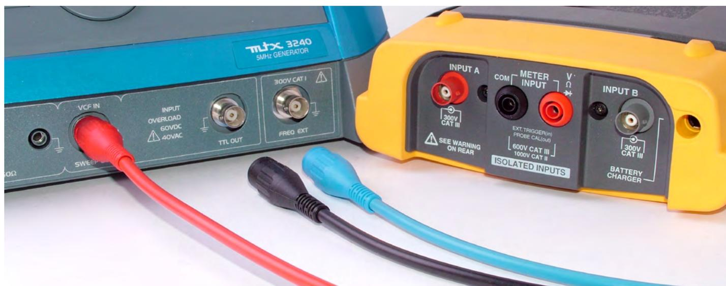
Messleitungen mit berührungsgeschützten BNC-Steckern lassen sich an Geräte mit isolierten und herkömmlichen BNC-Buchsen anschließen.
